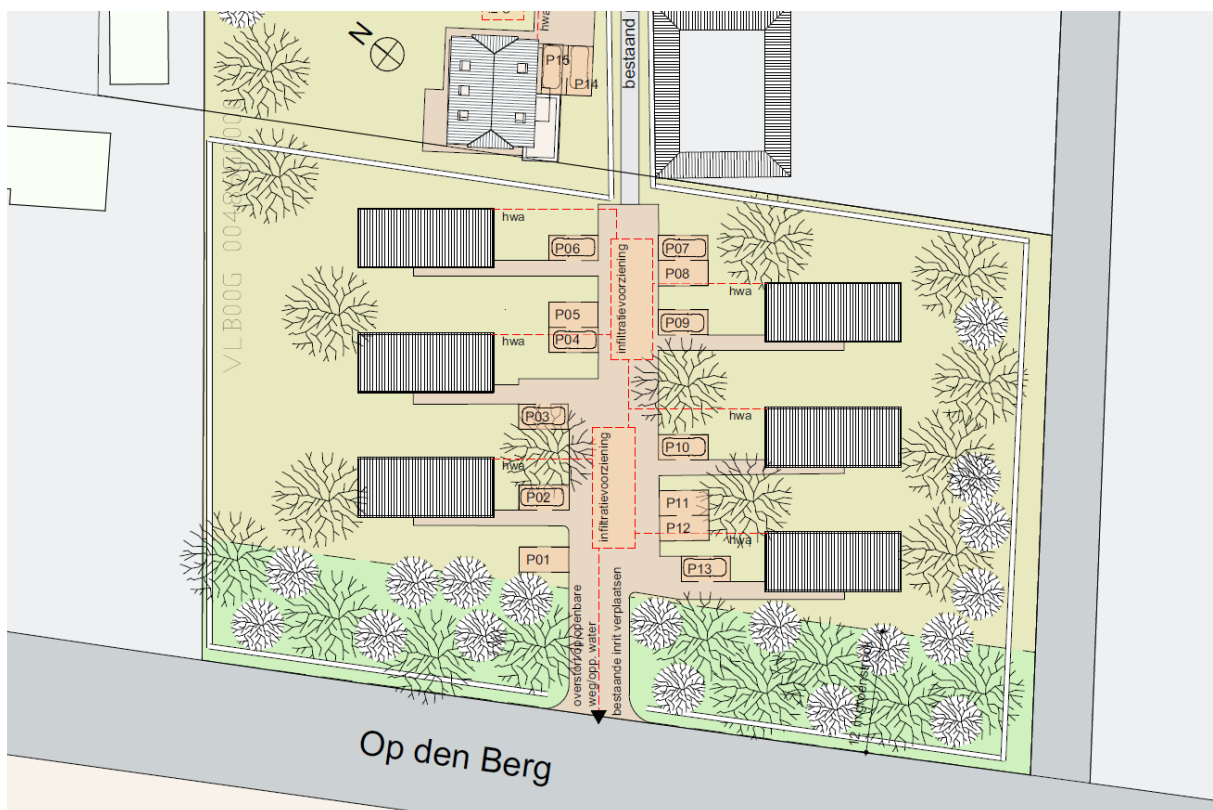
Infiltratievoorziening bij chalets
